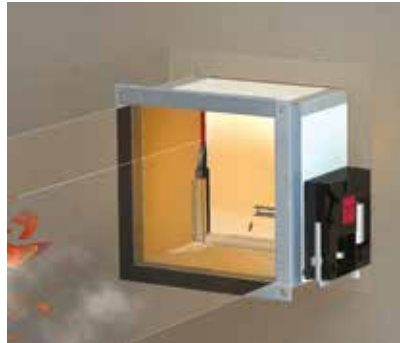
Ein Feuer bricht aus und die Temperatur erreicht 72 °C. Das Schmelzlot schmilzt und das Klappenblatt schließt sich.
