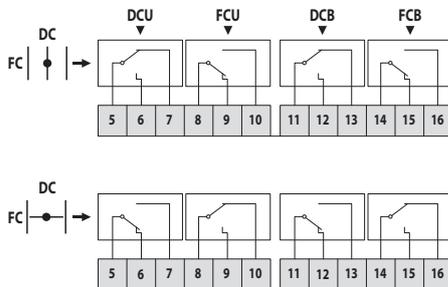
DC : Contact position ouverte du clapet
