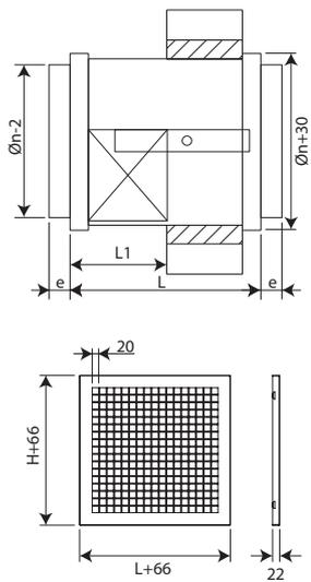
**PRJ** Raccordement circulaire avec joint d'étanchéité.
