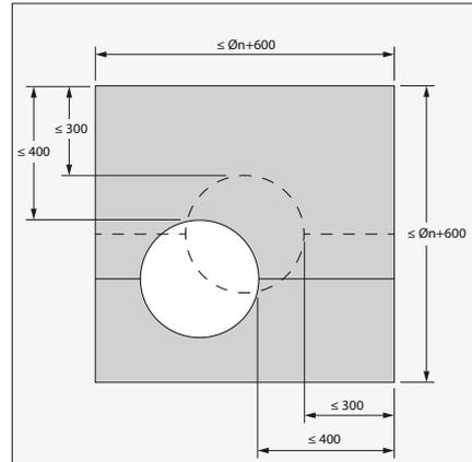
6. Le clapet peut mais ne doit pas être centré dans la réservation (de dimensions maximales clapet + 600 mm). Une distance maximale de 400 mm doit être respectée par rapport au bord de la réservation.
