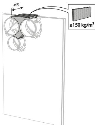
7. Installez et fixez les clapets dans la réservation.
