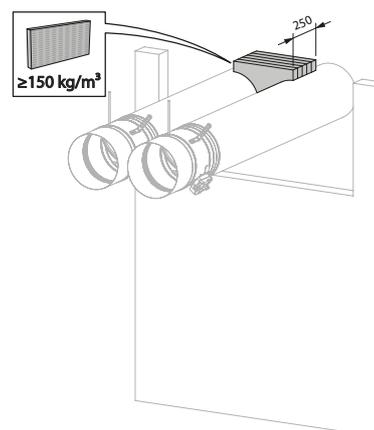
10. Colmatez la réservation du côté des distances minimales à l'aide de panneaux rigides de laine de roche ( $150 \text{ kg/m}^3$ ) sur une profondeur de 250 mm (épaisseur de la paroi + additionnel à l'arrière de la paroi).
