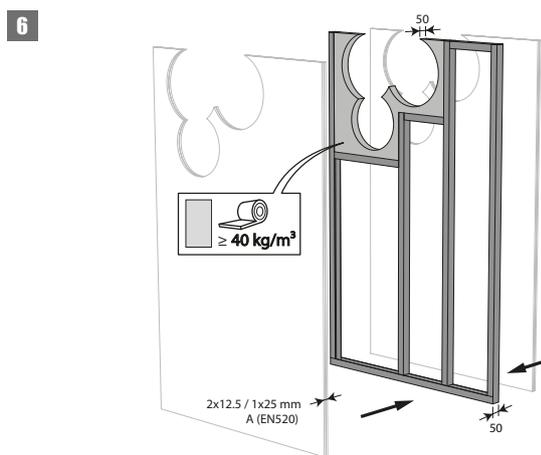
5. Les clapets peuvent être installés à distance minimale ( $\geq 30$  mm) d'une paroi ou d'un autre clapet.
