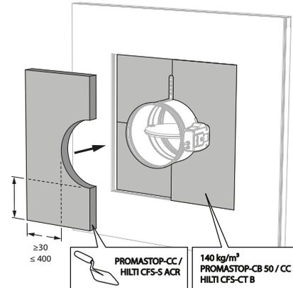
2. Le colmatage s'effectue au moyen de 2 couches de panneaux de laine minérale d'épaisseur 50 mm. Les 2 couches sont posées à joints décalés et ces joints sont recouverts sur tout le contour d'enduit.
