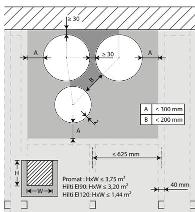
7. Les clapets peuvent être installés à distance minimale ( $\ge 30$  mm) d'une paroi ou d'un autre clapet.
