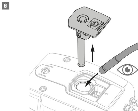
6. Tirer simultanément le fusible et la protection en caoutchouc pour l'extraire du mécanisme. Introduisez la caméra de l'endoscope (par exemple Inspecam Rf-t) dans l'ouverture et inspectez l'intérieur du clapet. Remplacez la fusible thermique dans le mécanisme jusqu'à ce qu'il s'enclique. Fermez le compartiment de la pile avec la protection en caoutchouc.
