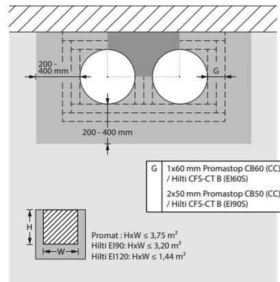
8. Les clapets peuvent être installés à distance minimale d'une paroi ou d'un autre clapet.
