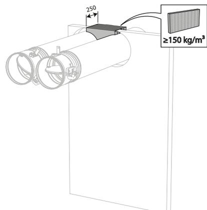
10. Colmatez la réservation du côté des distances minimales à l'aide de panneaux rigides de laine de roche ( $150 \text{ kg/m}^3$ ) sur une profondeur de 250 mm (épaisseur de la paroi + additionnel à l'arrière de la paroi).
