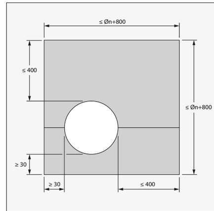
4. Le clapet peut mais ne doit pas être centré dans la réservation (de dimensions maximales  $\varnothing$  clapet + 800 mm). Une distance maximale de 400 mm doit être respectée par rapport au bord de la réservation.
