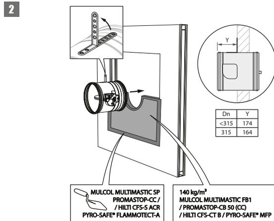
2. Le colmatage s'effectue au moyen de 2 couches de panneaux de laine minérale d'épaisseur 50 mm recouverte d'enduit coupe-feu sur une face (type PROMASTOP-CB 50 / PROMASTOP-CB/CC 50 / HILTI CFS-CT B / Mulcol Multimastic FB1 / PYRO-SAFE® MFP).
