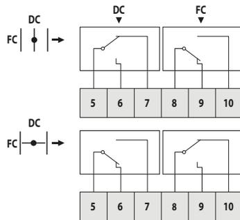
DC : Contact position ouverte du clapet
