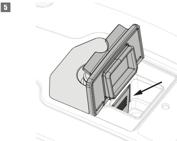
5. Appuyez sur le bouton flexible à l'intérieur du compartiment de la pile.
