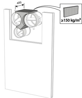
10. Colmatez la réservation du côté des distances minimales à l'aide de panneaux rigides de laine de roche ( $\geq 150 \text{ kg/m}^3$ ) sur une profondeur de 400 mm (150 mm du côté mécanique de la paroi).
