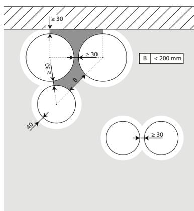
3. Les clapets peuvent être installés à distance minimale (≥ 30 mm) d'une paroi ou d'un autre clapet.
