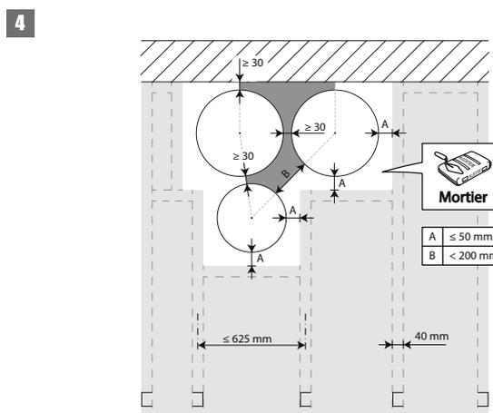
4. Les clapets peuvent être installés à distance minimale ( $\geq 30$  mm) d'une paroi ou d'un autre clapet.
