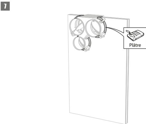
7. Colmatez le reste de la réservation à l'aide de plâtre standard sur l'épaisseur totale de la paroi.
