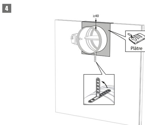
3. Les clapets peuvent être installés à distance minimale ( $\geq 40$  mm) d'un plafond ou d'une dalle.
