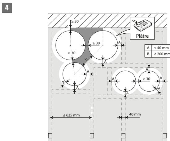
4. Les clapets peuvent être installés à distance minimale (≥ 30 mm) d'une paroi ou d'un autre clapet.
