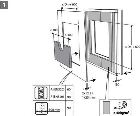
1. Dans le cas d'une paroi flexible, prévoir un chevêtre autour de la réservation. Exception : en cas de colmatage avec des panneaux de type Promastop ou Hilti, il n'est pas nécessaire, du point de vue de la protection incendie, de prévoir un chevêtre autour de la réservation.
