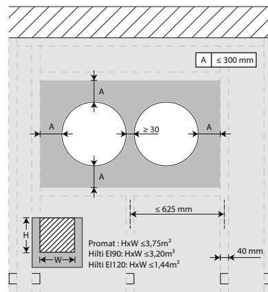
8. Voir les détails sous 'Montage en paroi flexible et massive, colmatage à l'aide de panneaux de laine de roche rigides et enduit'
