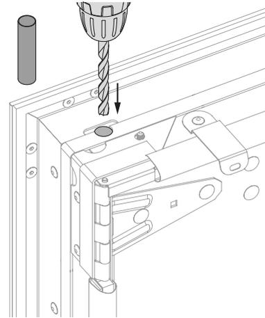
2. Percez le matériau réfractaire dans l'encoche dans l'angle/les angles choisi(s). La partie métallique à l'intérieur du volet est préperçée.
