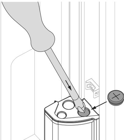
3. Percez l'ouverture dans la boîte de raccordement. Montez le passe-fil livré avec le produit.
