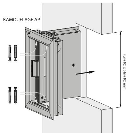
2. Faites une baie aux dimensions  $(L+10) \times (H+10)$  mm. Vissez le volet dans la baie à l'aide de 4 vis et chevilles  $\varnothing 6 \times 60$  mm.
