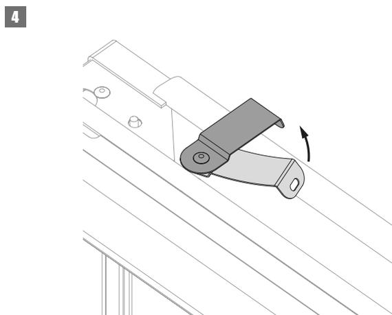
4. Aux quatre angles du volet, faites pivoter les pattes de fixation à  $90^\circ$  (jusqu'à la butée).
