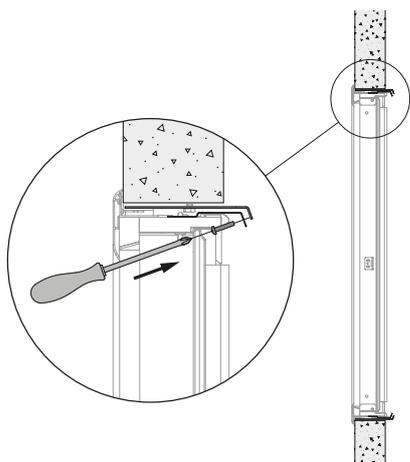
5. Ouvrez le volet et positionnez-le dans le précadre. Vissez le volet sur le précadre à l'aide des 4 vis fournies, comme indiqué sur le dessin. Le serrage des vis tire le volet vers le mur jusqu'à sa position finale. Il permet également de corriger légèrement l'angle du volet par rapport au précadre. Branchez le mécanisme selon le schéma de raccordement.
