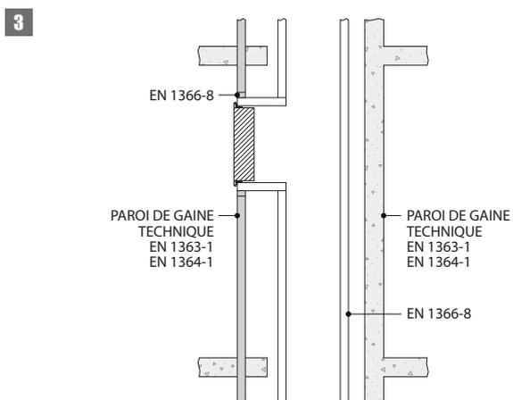
3. Exemple d'installation dans un conduit
