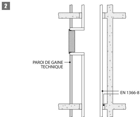
2. Exemple d'installation dans un conduit
