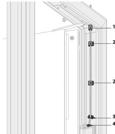
4. Faites passer les câbles par l'ouverture. Utilisez le manchon de protection (1), les clips de fixation (2) et le collier serre-câble (3) pour fixer les câbles au cadre. Introduisez les câbles dans la boîte de raccordement par le passe-fil (4) et raccordez selon le schéma de raccordement.
