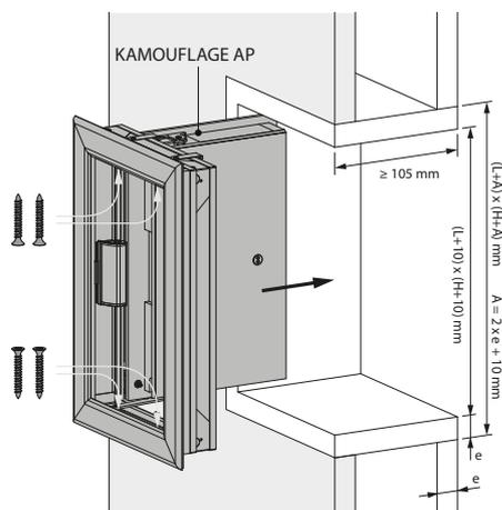
3. Exemple de montage dans une dérivation d'un conduit vertical, avec une finition pré-murale.
