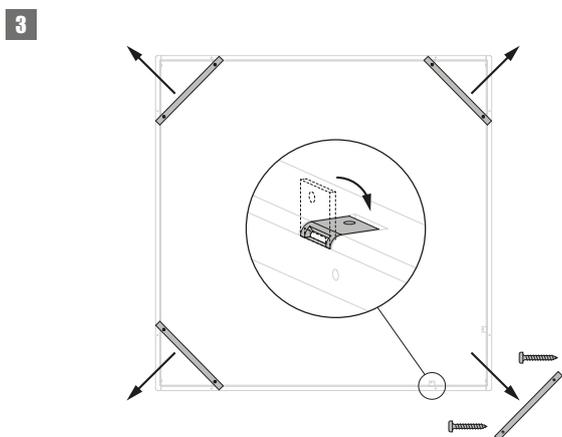
3. Mettez de côté les vis qui sont fixées à l'un des renforts, puis dévissez les 4 renforts du précadre et repliez les 8 pattes de fixation dans le cadre.
