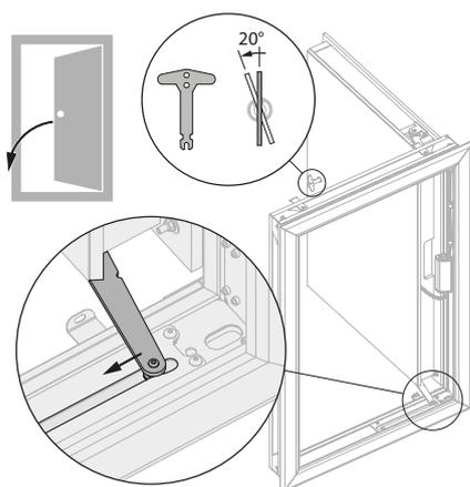
1. Tournez la clé à 20° dans le sens anti-horaire. Appuyez sur le bras d'actionnement dans le sens de la flèche et tirez le vantail en position fermée.
