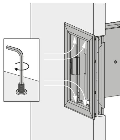
6. Serrez les vis de positionnement jusqu'à ce qu'elles soient juste contre le conduit, sans déformer le cadre. Ces vis empêchent le Kamouflage AP de s'affaisser dans l'ouverture.
