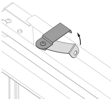
1. Aux quatre angles du volet, faites pivoter les pattes de fixation à 90° (jusqu'à la butée).
