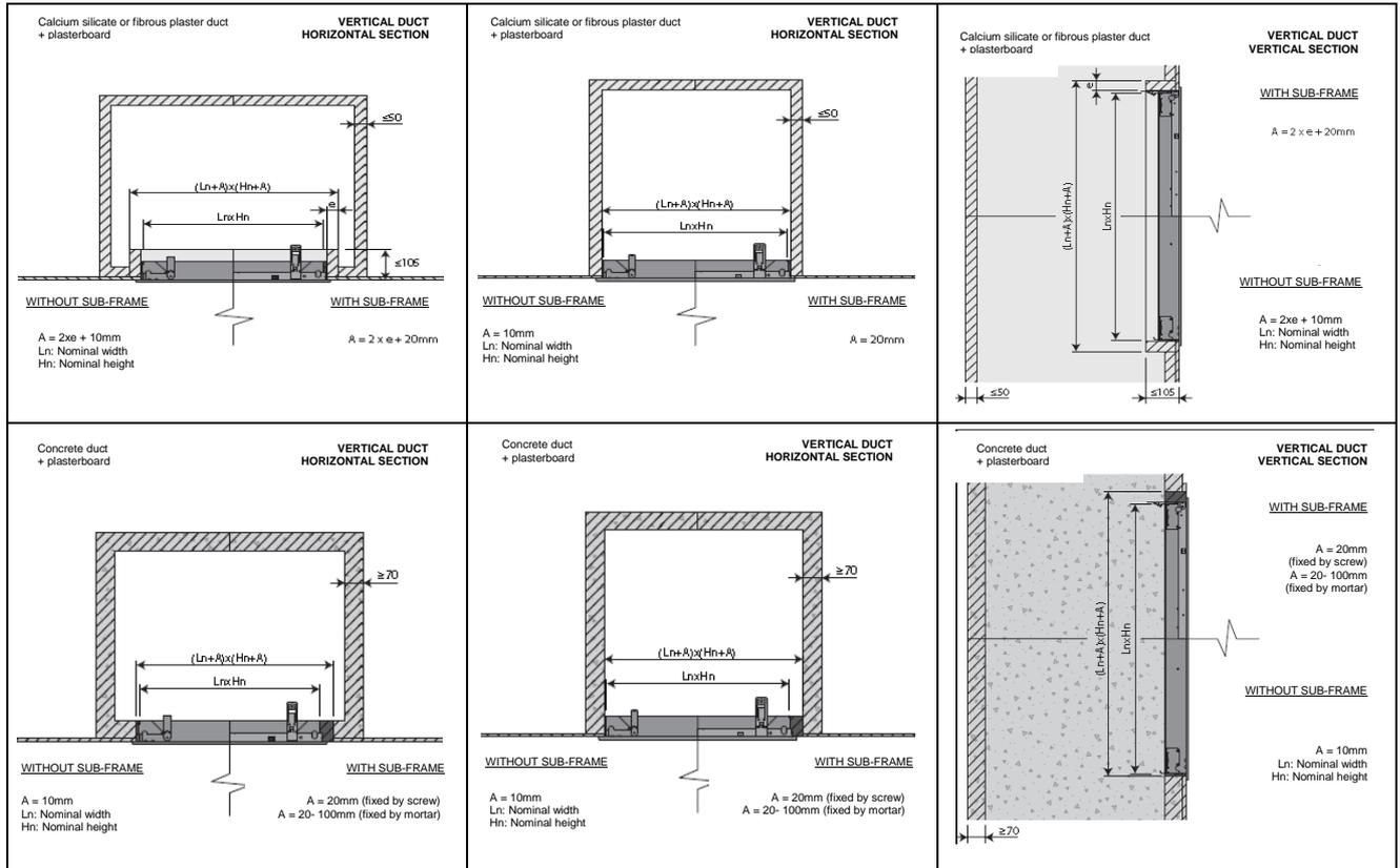
**7.4. IMPLEMENTATION OF A WALL IN FRONT OF THE SLEEVE OR DUCT CONTAINING THE DAMPERS**
