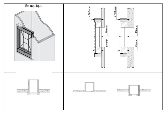
Pour l'installation encastrée de chaque volet dans des conduits Promatect ou Geotec, une réservation est réalisée sur une face de conduit :
