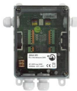
Le module de champ ZENIX 2FD est utilisé pour surveiller et contrôler jusqu'à 2 clapets coupe-feu motorisés avec servomoteurs 230 V. Aucune configuration n'est requise car il a une adresse prédéfinie.
