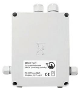
Le module de champ ZENiX 1SSH est utilisé pour surveiller et contrôler 1 volet de désenfumage motorisé 24 V. Le moteur du volet fonctionne via 2 fils : la commutation de la polarité permet à la lame de se déplacer dans l'autre sens. Le ZENiX 1SSH possède 4 entrées numériques et 2 sorties relais.
