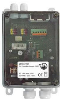
Le module de champ ZENIX 1SD est utilisé pour surveiller et contrôler 1 volet de désenfumage motorisé avec servomoteur 230 V. Aucune configuration n'est requise car il a une adresse prédéfinie.
