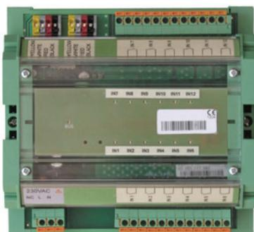
Le ZENiX DI12 est un module de champ avec 12 entrées numériques, libre de potentiel. Il peut être utilisé pour connecter des entrées d'alarme supplémentaires provenant du panneau de détection d'incendie. Il peut également être utilisé pour connecter d'autres entrées telles que les interrupteurs de fin de course des clapets mécaniques par exemple.
