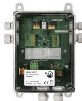
Le module de champ ZENiX 2MFD est utilisé pour surveiller jusqu'à 2 clapets mécaniques (autocommandés). Aucune configuration n'est requise car il a une adresse prédéfinie.
