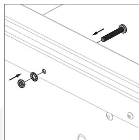
7. Bevestig de bijgeleverde M5 bouten (kop van de schroef aan de binnenzijde van de klep).
