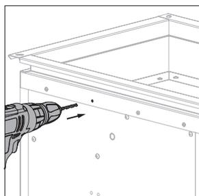
6. Percez ces trous centraux de par en par avec une mèche de 5mm de diamètre.
