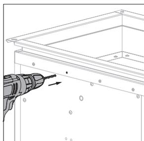
6. Boor deze centrale gaten langs elke zijde uit op diameter 5mm.
