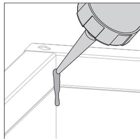
3. Spuit de hoeken dicht met silicone.
