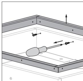
1. Schroef de bevestigingsbouten van de huidige PS kader los en verwijder die kader.
