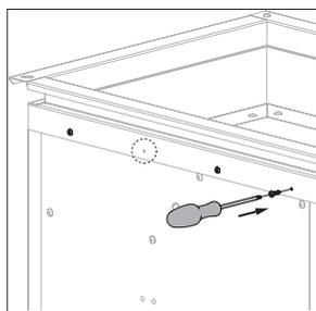
5. Fixez le cadre en place à l'aide des vis pour aggloméré de 40 x 1.5mm livrées excepté un des trous centraux sur chaque côté du cadre.
