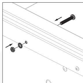
7. Fixez les boulons M5 livrés (tête de la vis du côté intérieur du volet).
